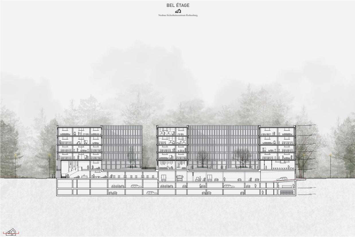
Längsschnitt A-A | M 1:200
